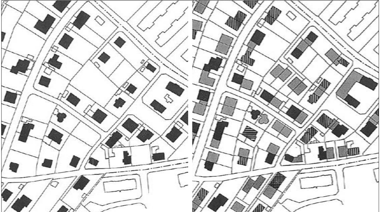
Abbildung: Flächenpotenziale für Baulandgewinnung in jüngeren Einfamilienhausgebieten mit lockerer Einfamilienhausbebauung - vor einer Nachverdichtung (Bild links) und danach (Bild rechts), Quelle: Rosenberger, 1996.
